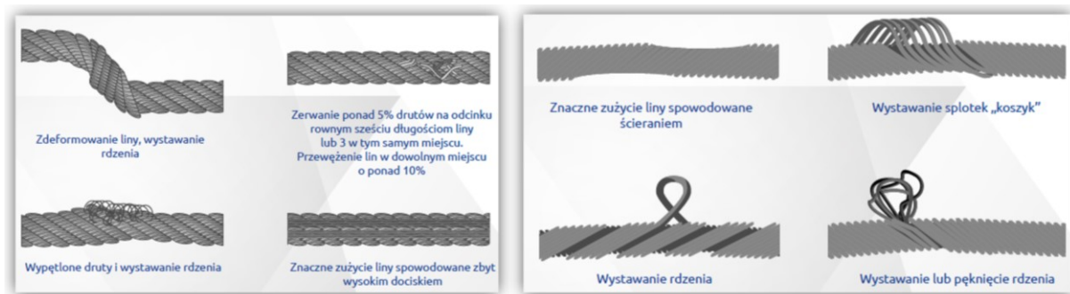
Rysunek 21 Zawiesia linowe – znamiona uszkodzeń
