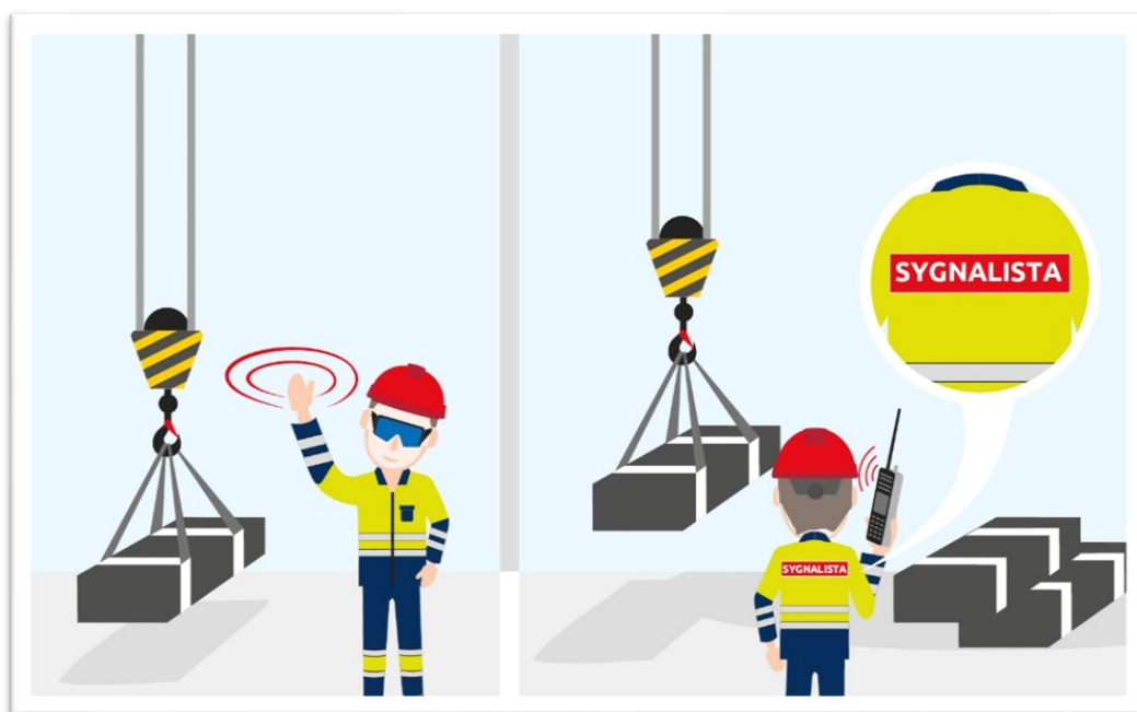
Rysunek 23 Komunikacja sygnalisty z operatorem urządzenia dźwignicowego.
